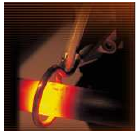
Chauffe d'une barre cylindrique
